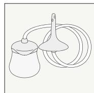
Lokket har en enveisventil slik at pumpen kan klemmes mer enn én gang, uten at luft eller vann suges tilbake i pumpen under bruk. Derfor vil pumpen holdes komprimert til lokket åpnes.
