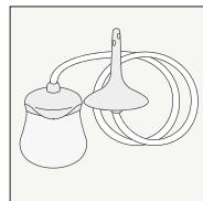
La tapa tiene una válvula unidireccional, por lo que la bomba puede apretarse más de una vez, sin que el aire o el agua se aspiren de vuelta a la bomba durante el uso. Por este motivo, la bomba permanecerá comprimida hasta que se abra la tapa.
