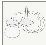
Låget har en envejsventil, så der kan trykkes flere gange på pumpen, uden at luft eller vand suges tilbage i pumpen under brug. Derfor vil pumpen forblive sammenpresset, indtil låget åbnes.
