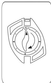
Das System funktioniert durch das schrittweise Drehen des Reglers im Uhrzeigersinn in den Positionen 1-2-3-4.
