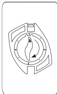
El sistema funciona al girar hacia la derecha la unidad de control paso a paso en las posiciones 1-2-3-4.
