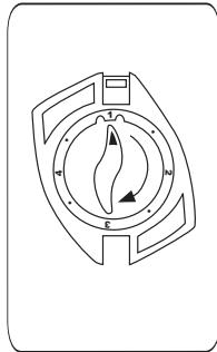
Systemet används genom att kontrollenheten vrids medurs steg för steg till lägena 1-2-3-4.
