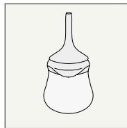
Il coperchio ha una valvola di non ritorno che impedisce che l'aria o l'acqua vengano risucchiati nella pompa anche se la pompa viene compressa più di una volta. Per questo motivo la pompa rimarrà schiacciata se il coperchio è aperto.
