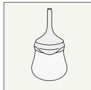
Locket har en backventil, så pumpen kan klämmas ihop mer än en gång utan att luft eller vatten sugs tillbaka in i pumpen under användning. Pumpen kommer därför att förbli hoptryckt tills locket öppnas.
